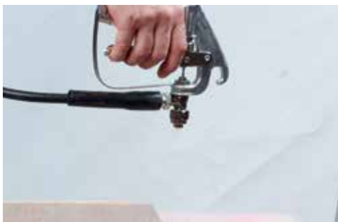
2. Spuit de materiaalslang volledig leeg tot er geen lijm en drijfgas meer uitkomt.
